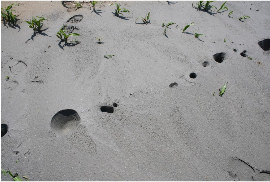
Fig. 4 – Dettaglio di terreno liquefatto con mulinelli di fango (sand boils) presso Gavello Ferrarese (zona epicentrale)
